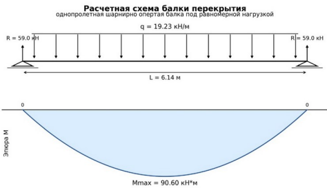
Расчетная схема балки перекрытия
