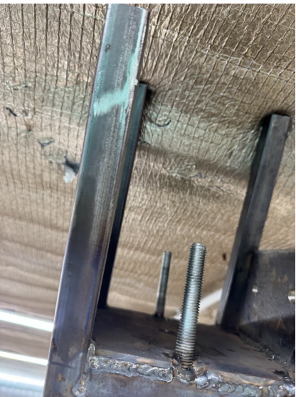
3. Обновление 2/5: шпильки над пластиной
